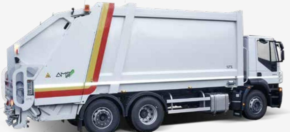
SPX HARD WORK, con cassone da 22 a 30 m<sup>3</sup>, è un compattatore a caricamento posteriore con peculiari caratteristiche che lo rendono particolarmente idoneo al lavoro gravoso in contesti industriali.
